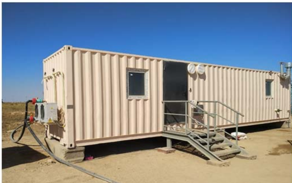
Рисунок 5 – Общий вид опытно-промышленной мобильной установки активации выщелачивающих растворов
