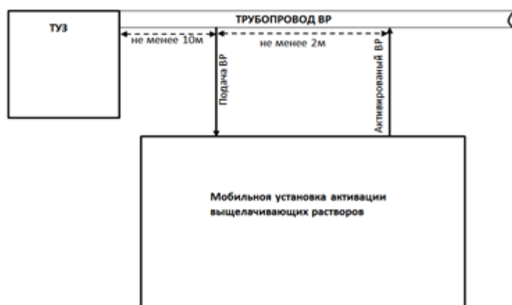
Рисунок 3 – Точки подключения опытно промышленной УАВР к технологическим коммуникациям
